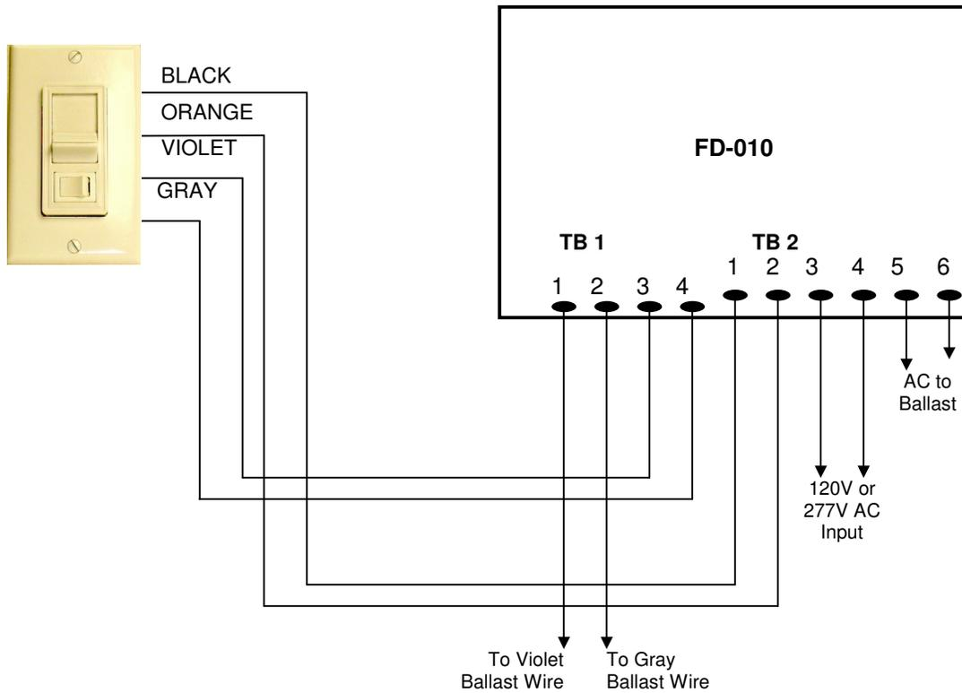
POLARITY MUST BE MAINTAINED FOR PROPER OPERATION
